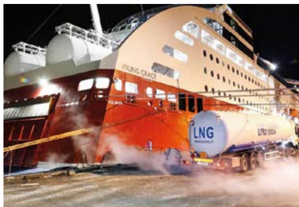
Image 18: MV Viking Grace – truck-to-ship LNG bunkering.
